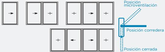
Los sistemas de puertas Osciloparalelas High 70 son sistemas practicable de carpintería de aluminio en el que un herraje especial, hace que la hoja se deslice sobre unos carriles, ya sea de forma manual o automática. Este sistema permite hojas de hasta 200 kg.
